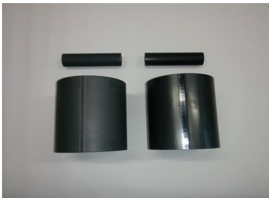
酸洗・パーカー処理後(左)、酸洗処理前(右)
